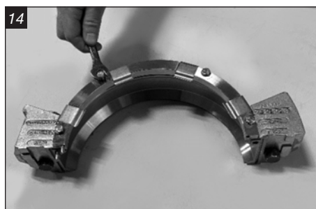
Fjern (8x) sekskanthodebolter som forbinder fjærplaten til glanden. Fjern fjærplatehalvdelen fra glandhalvdelen.
