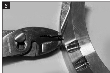
8 Fjern sentreringsknapper på (6x) den ytre diameteren til roterende klamme.
