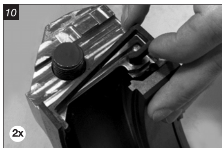
Fjern glandpakninger fra glandslisser.
