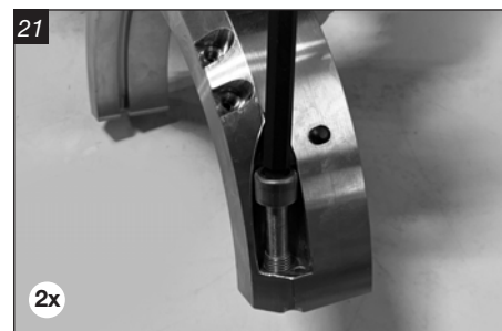
Smør gjengene med anbefalt skillemiddel og installer klammehodeskruer i roterende klammehalvdel.
