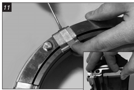
Fjern (6x - 8x) fjærsikringer fra glandhalvdelen. Merk: Når den siste sikringen er fjernet kan den stasjonære tetningsringen fjernes.
